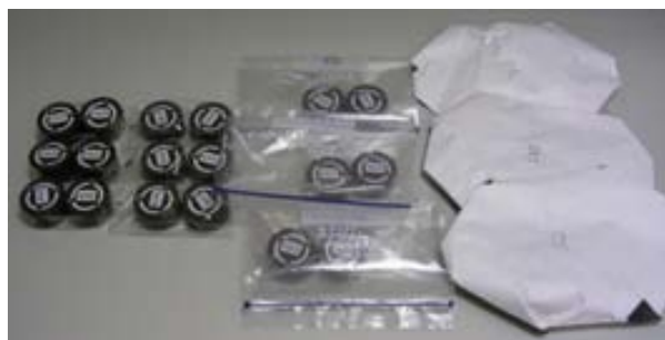
Figura 3.43. Detectors de Makrofol amb les configuracions, d'esquerra a dreta, a (sense bossa), C (bossa Treseses), D (bossa Zipdar) i B (bossa Tyvek).
