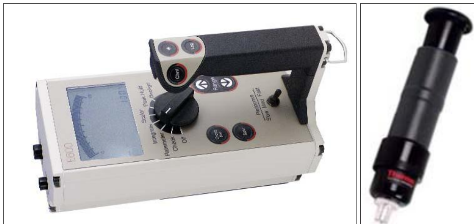
Figura 3.14. Esquerra: El monitor Eberline E600. Dreta: La sonda HP-270.
