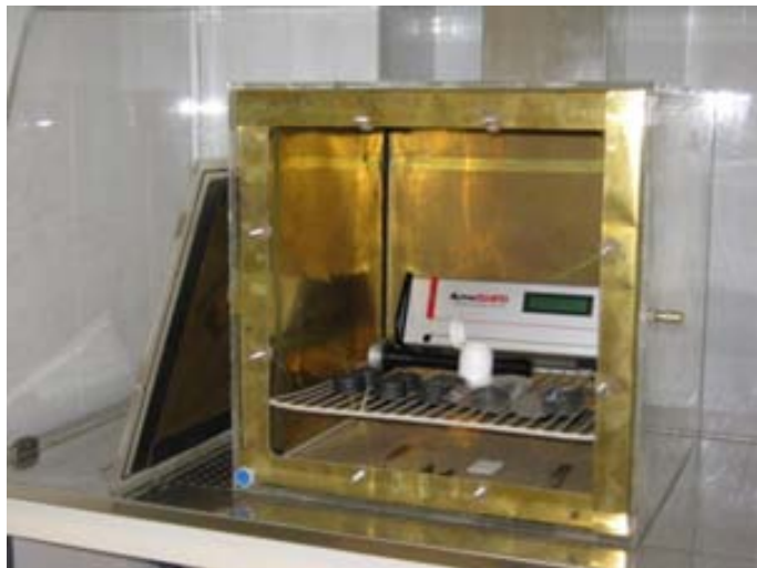
Figura 3.13. Cambra de radó de la UFR de la UAB oberta on s'observa el monitor AlphaGUARD, un pot de pechblenda i alguns detectors de Makrofol en el seu interior.
