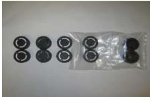
Figura 3.41. Les cinc configuracions de detectors de Makrofol analitzades inicialment per evitar la humitat (d'esquerra a dreta: a, b, c, d i e).
