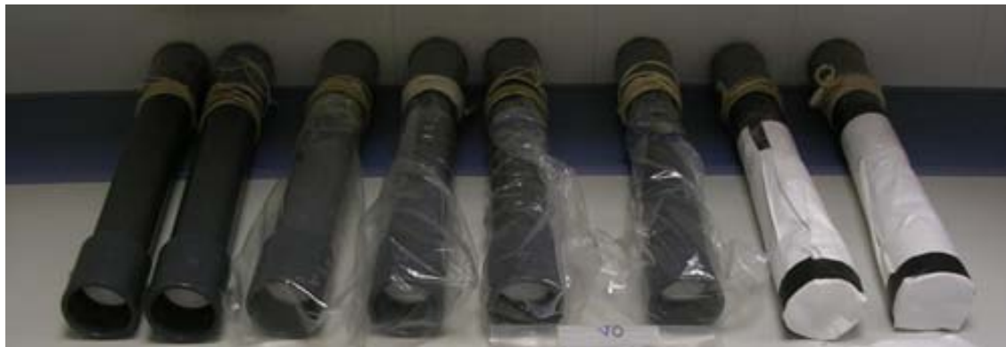
Figura 3.52. Detectors de LR115 amb les quatre configuracions (d'esquerra a dreta): A (sense bossa), C (Treseses), D (Zipdar) i B (Tyvek).
