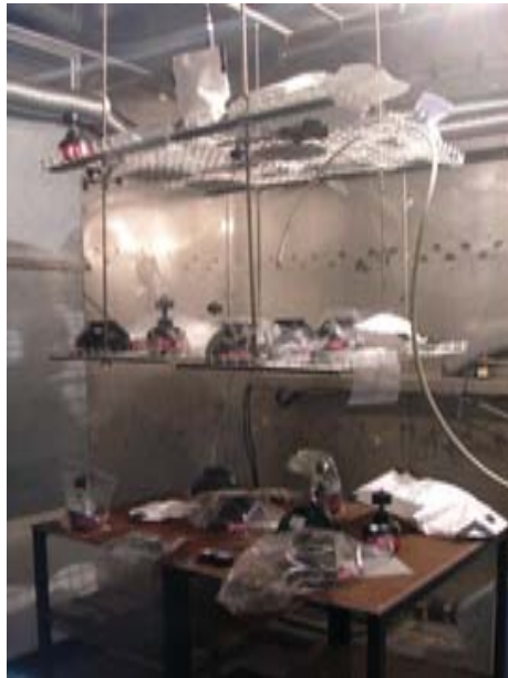
Figura 3.22. Muntatge de l'exposició de detectors passius dins la cambra de radó de l'INTE de la UPC.
