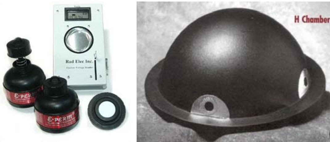
Figura 3.11. Esquerra: Cambres de ionització model S, una oberta i una tancada, un electret ST i el Lector d'Electrets. Dreta: una cambra de ionització model H.
