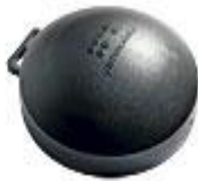
Figura 3.10. La cambra de difusió de NRPB/SSI amb detector de CR-39 en el seu interior.
