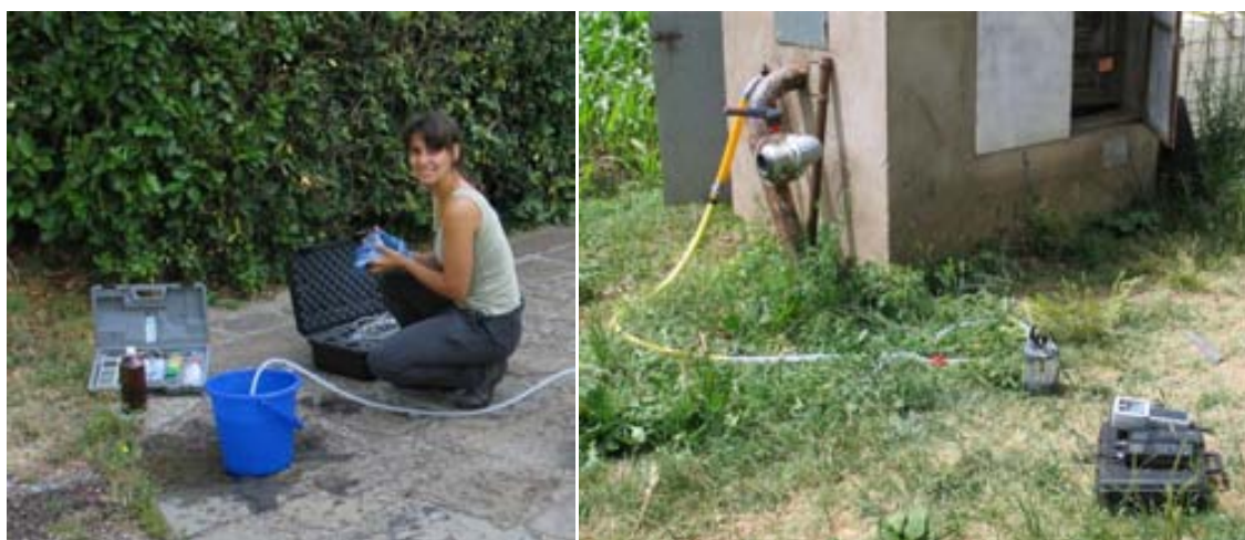
Figura 3.17. Esquerra: mostreig d'aigua procedent d'un pou on es mostra el conductímetre per mesurar la temperatura i la conductivitat. Dreta: mesura de paràmetres de camp amb la cel·la de flux.
