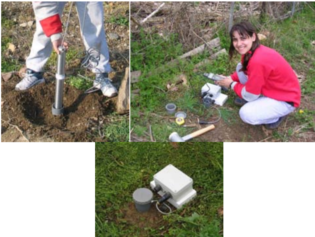
Figura 3.5. La sonda Clipperton II instal·lant-se en el camp dins un tub de PVC (superior esquerra), programant-se amb la computadora Psion (superior dreta) i alimentant-se amb bateries externes (inferior).
