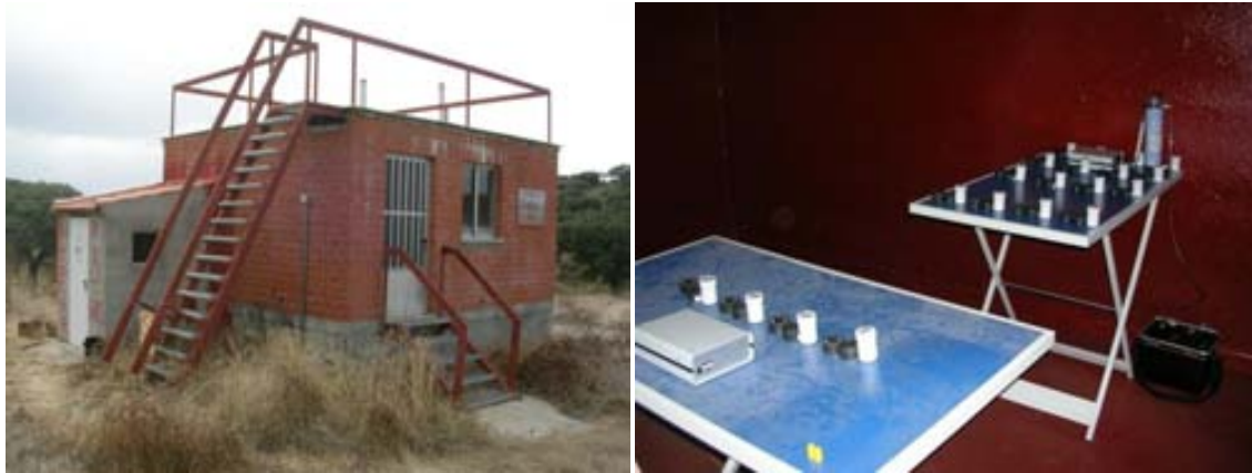
Figura 3.28. Esquerra: Mòdul experimental de Saelices el Chico (Salamanca). Dreta: Muntatge de la primera exposició de detectors passius i actius a l'interior del soterrani del mòdul.
