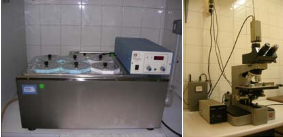
Figura 3.9. Esquerra: Bany tèrmic del revelatge químic dels detectors de LR115. Dreta: Microscòpic òptic amb cambra CCD acoblada per la lectura i captació d'imatges de les traces en els detectors de LR115.
