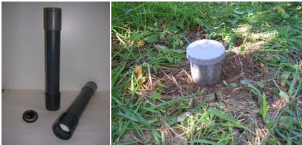
Figura 3.8. Esquerra: detector de LR115 situat a la cambra de difusió amb filtre de fibra de vidre per mesures del radó en el sòl. Dreta: Tub de PVC clavat en el sòl a l'interior del qual s'instal·la el detector de LR115 i l'aïllant tèrmic.
