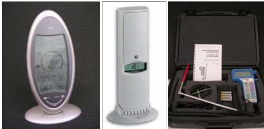
Figura 3.15. Estacions meteorològiques TFA principal (esquerra) i auxiliar (centre) i velocímetre d'aire VelociCalc Plus (dreta).
