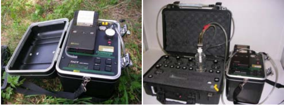
Figura 3.4. Esquerra: Monitor RAD7 realitzant una mesura de la C_{Rn} a l'aire. Al seu damunt hi ha una petita impressora que permet disposar d'un registre escrit dels resultats al llarg de la mesura. Dreta: Monitor RAD7 realitzant una mesura d'una mostra d'aigua amb l'accessori RAD H 2 O.
