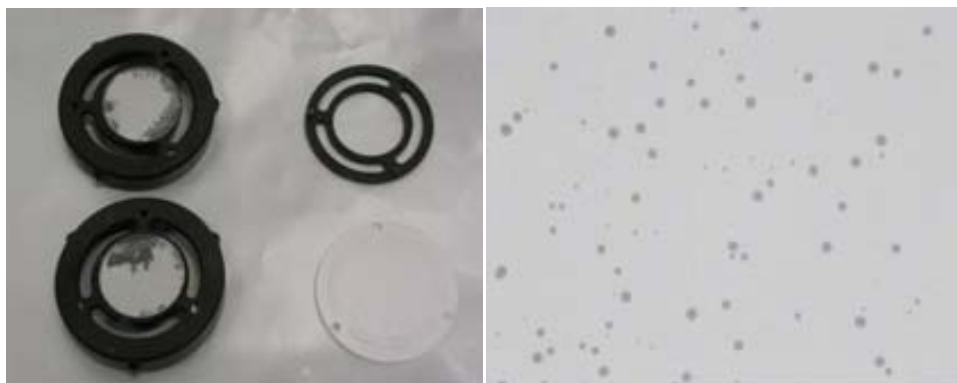
Figura 3.51. Esquerra: Detectors de Makrofol exposats amb filtre de fibra de vidre i de polietilè presenten deteriorament similars de la làmina de Mylar. Dreta: Les traces d'un detector revelat que tenia la làmina de Mylar molt deteriorada presenten una distribució homogènia.
