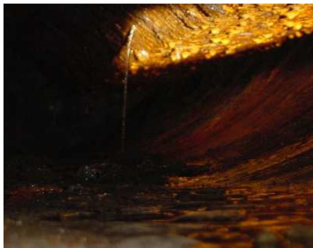
Figura 4.13 Ampliación del corte y fisura de la cuba del evaporador
