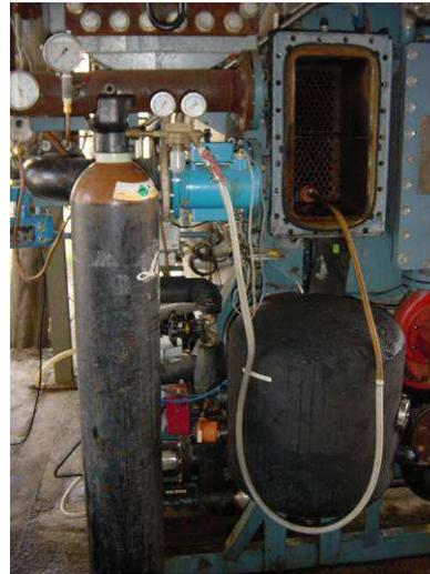
Figura 4.11 Prueba de estanqueidad de los tubos del evaporador
