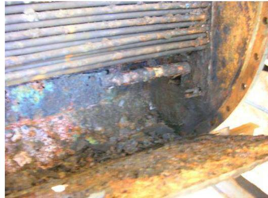
Figura 4.15 Corrosión en la cuba del evaporador E0
