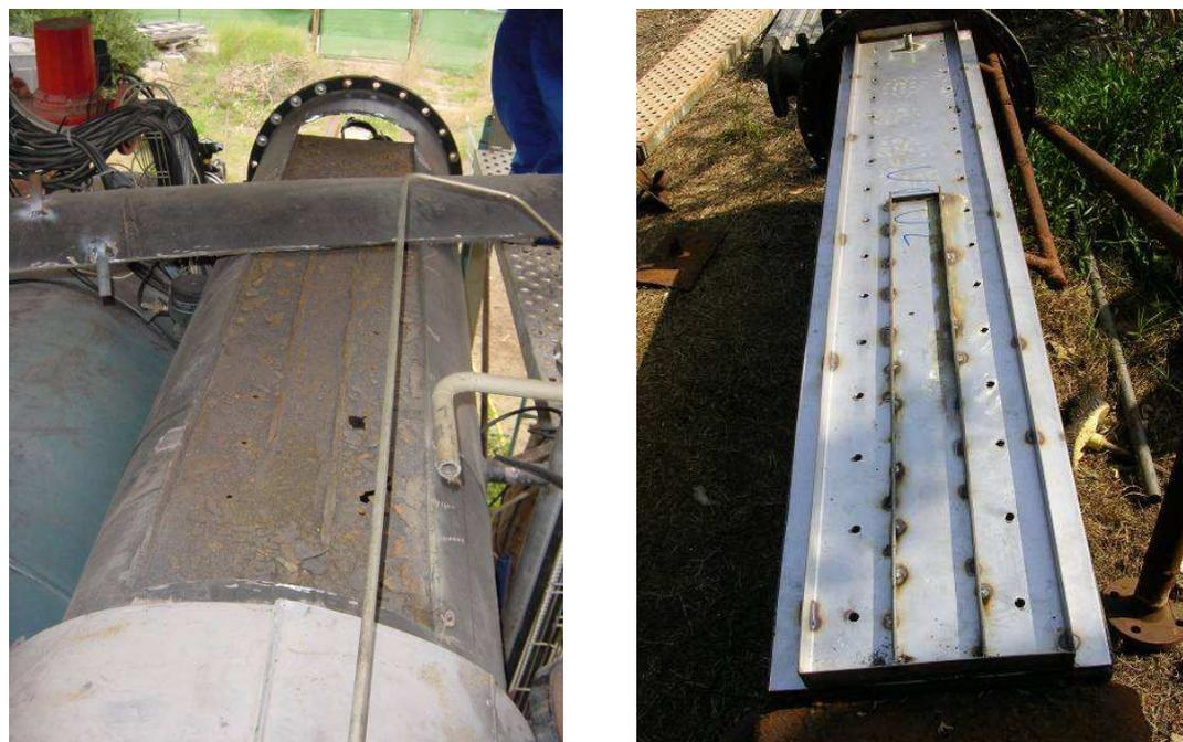
Figura 4.19 Estado de la bandeja pre-distribuidora del GA1 y la bandeja nueva con que se la substituyó.
