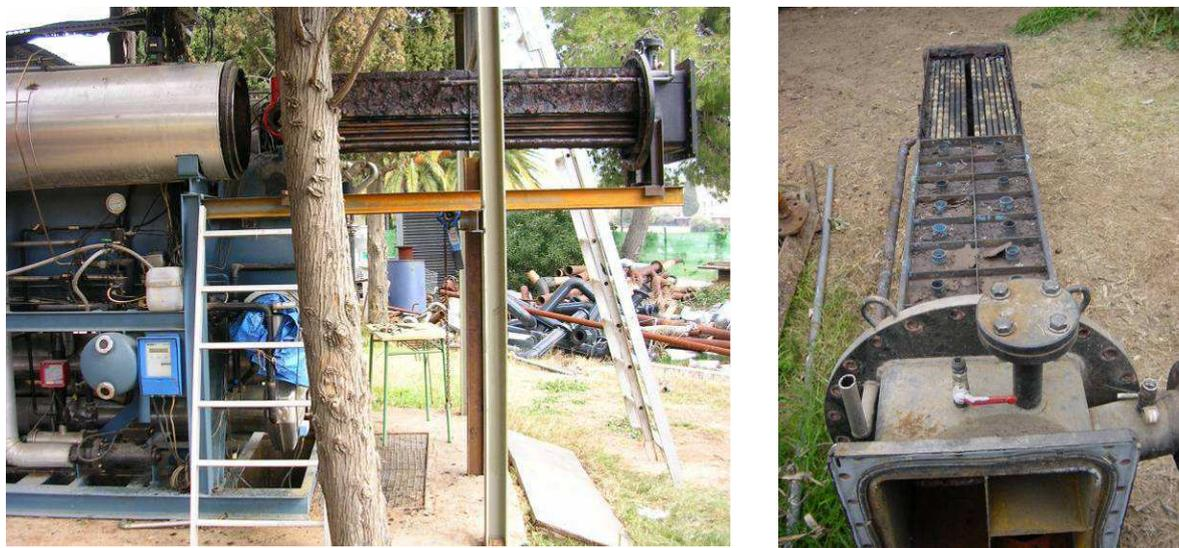
Figura 4.18 Generador/absorbedor de media presión
