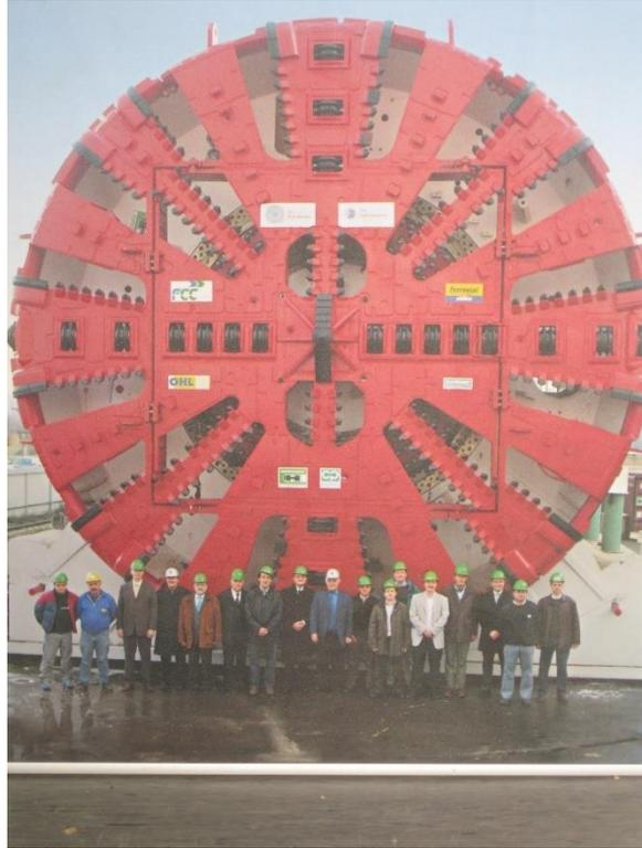
*Ilustración 5: Corona de la tuneladora EPB (Earth Pressure Balance). Fotografía UTE Tuneladora metro*
