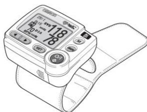
Dispone de un sensor de postura. Este sensor puede determinar la altura óptima de la muñeca (a la altura del corazón) en el momento de realizar la medición de la presión arterial. Medir a la misma altura del corazón es extremadamente importante, puesto que una posición más alta o más baja comportaría resultados erróneos.
