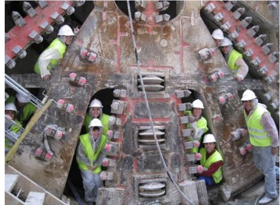
Imágenes del escudo y la cabeza de corte de una tuneladora EPB (Earth Pressure Balance) de la Línea 9 del metro de Barcelona en un momento de la visita formativa del personal operativo del IEM. Fotos IEM
