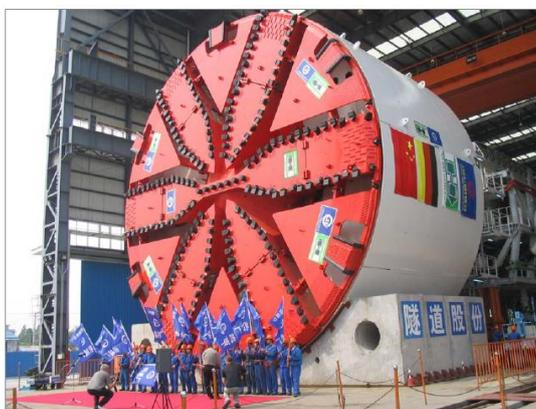
Tuneladora EPBs Herrenknecht con un diámetro de 15, 43 m, en Shangai, China.
