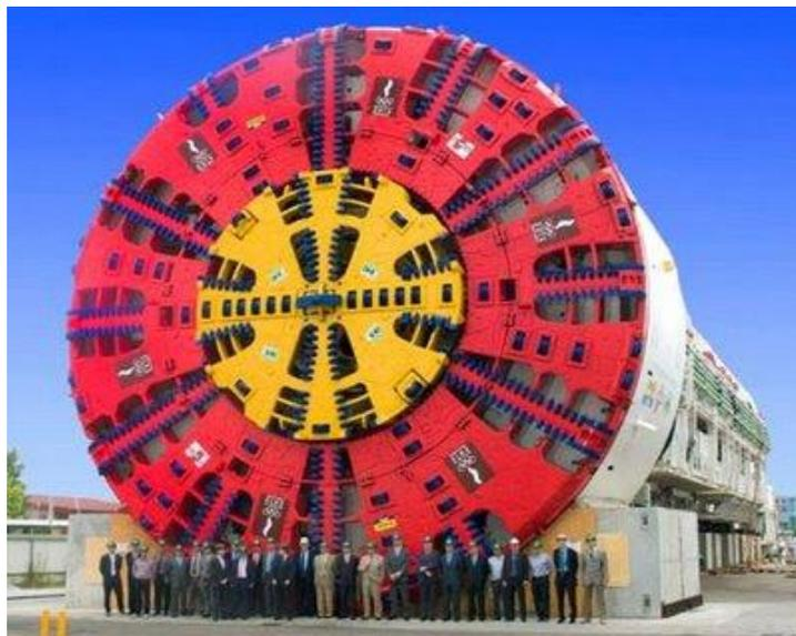
Tuneladora Dulcinea (Herrenknecht EPB Shield S-300). 4.364 toneladas de peso, longitud: 100 m (aprox.), diámetro exterior: 15,20 m, empuje: 316.000 kN, rendimiento máximo: 36 m/día y una potencia de 22.000 kW
