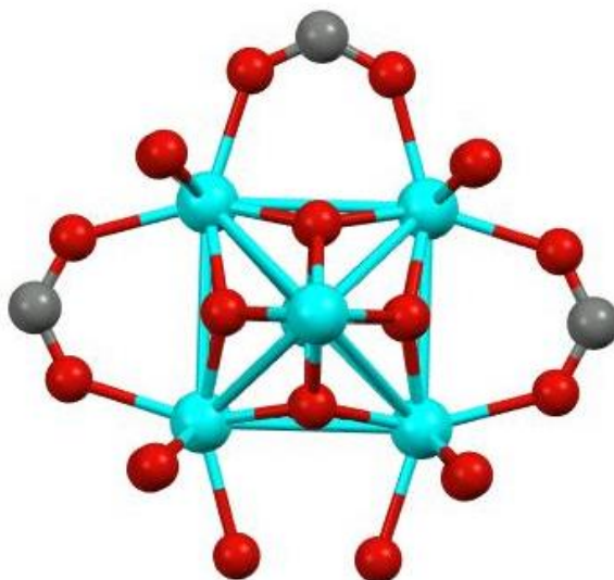
Figura 2. Unidad básica de construcción de la red metalo-orgánica UiO-66. Los átomos de carbono, oxígeno y metal se han representado en gris, rojo y turquesa, respectivamente. 58
