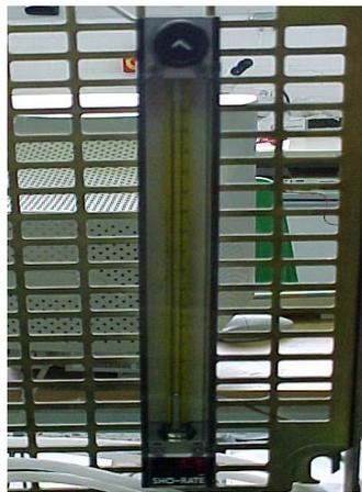
*Figura 3.8: Rotámetro para el control de flujo, 250 ml/min*
