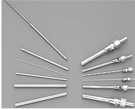
Figura 3.39: Tubos Inconel utilizados para el experimento
