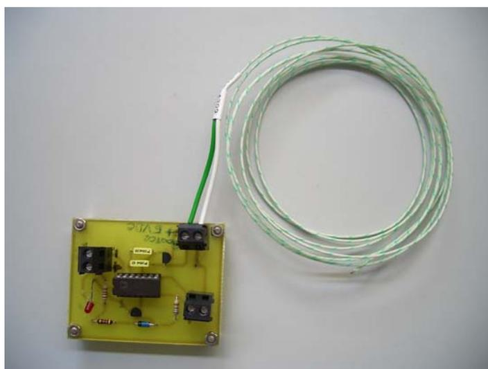
*Figura 3.49: Circuito de control de temperatura para el termopar tipo k*
