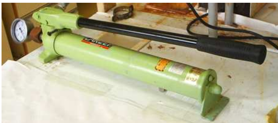
Figura 4.9. Bomba hidràulica del equip d'òsmosis inversa
