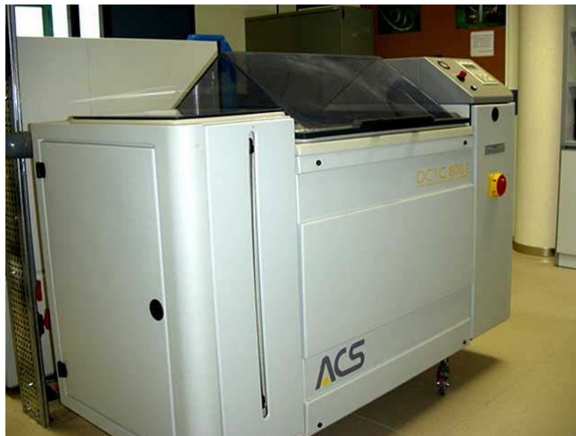
Figura 4.19. Cámara de niebla salina.
