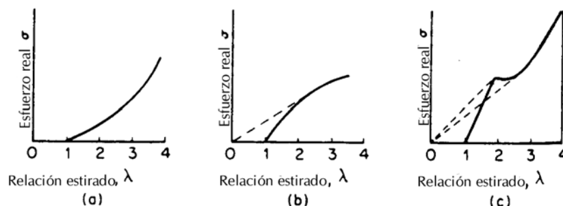
Figura 4.4: Representación de tres tipos de curvas de esfuerzo real-deformación en polímeros: (a) d\sigma/d\lambda > \sigma/\lambda ; (b) d\sigma/d\lambda = \sigma/\lambda en un punto, y (c) d\sigma/d\lambda = \sigma/\lambda en dos puntos.
