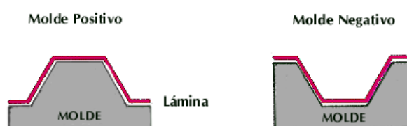
Figura 8.1: Esquema del conformado mediante molde positivo y negativo.
