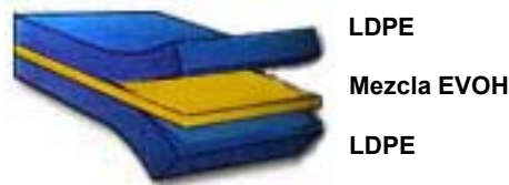
Figura 5.1: Esquema de los films multicapa coextruidos fabricados.
