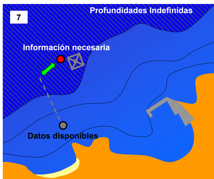
Figura 6.1. Representación de la ubicación de la información disponible y necesaria para la calibración puntual con datos en profundidades reducidas (supuesto N° 7 del capítulo 4).
