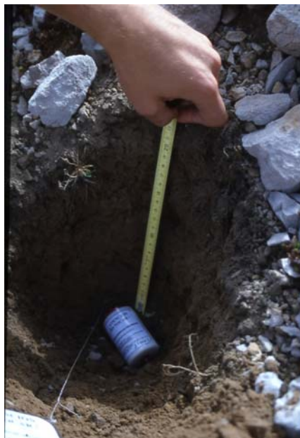
Figura 129. Los registros térmicos sobre la ladera NO de Peña Vieja han sido efectuados con termoregistradores Tipo HOBO UTL – 1 (Universal Temperatura Logger, Geotest AG). El modo de instalación ha sido enterrándolos a una profundidad establecida de entre 15 – 20 cm.
