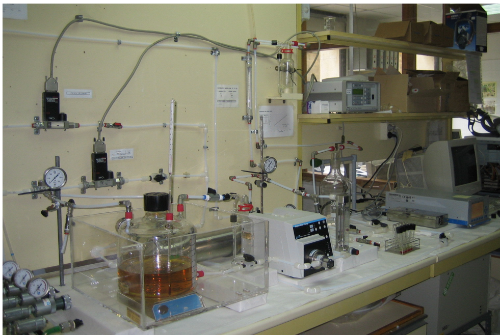
Figura 2.2. Fotografía de la instalación de la absorción no dispersiva de dióxido de azufre.
