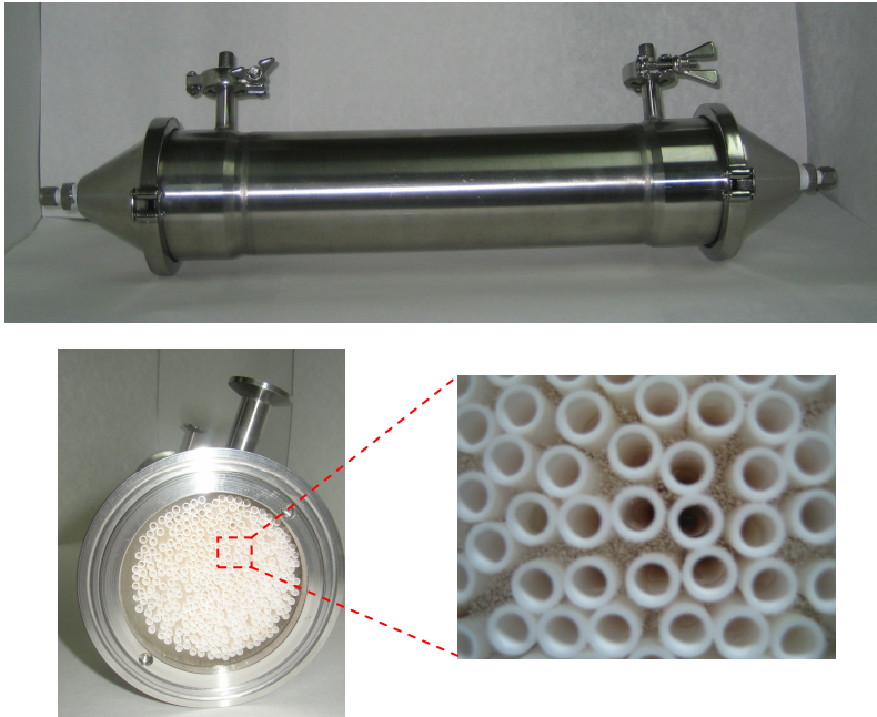
Figura 2.3. Módulo de fibras huecas cerámicas con un detalle ampliado de las fibras.
