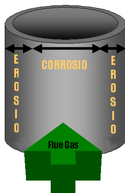
Fig.2.3 Esquema de la secció d'un tub on es mostren les diferents parts estudiades.
