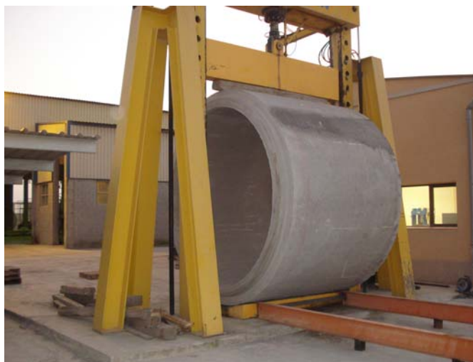
Fig. 1. Ensayo de tres aristas o de aplastamiento. Cortesía de PREFRAGA.
