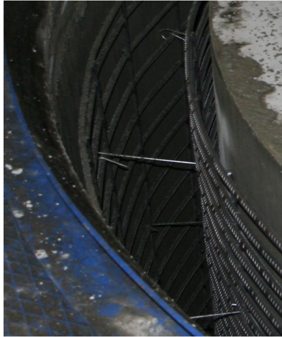
Fig.14. Estrategia empleada para garantizar los recubrimientos. Cortesía de PREFRAGA.
