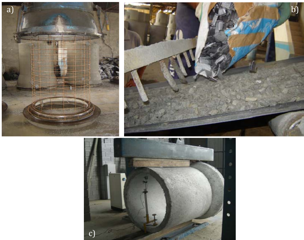
Fig. 1.1. (a) Jaula de armadura para un tubo de hormigón armado convencional, (b) vertido de fibras para la fabricación de un tubo de HRF y (c) ensayo de aplastamiento de un tubo de HRF.
