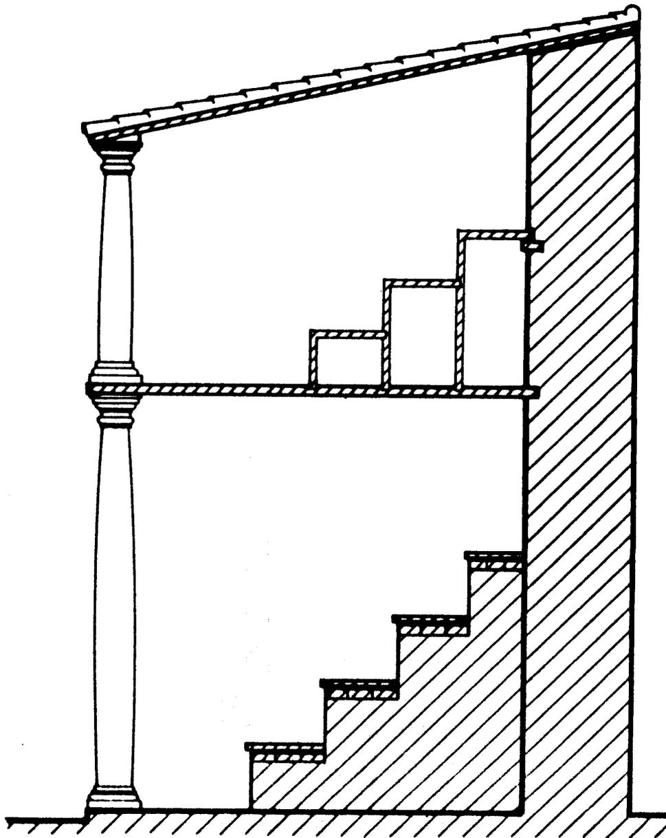
Fig. 11 Hipótesis de gradas bajas, gradas de cazuela y columnas (vista transversal)
