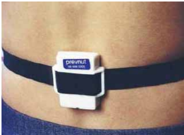
Figura 2. Exemple d'acceleròmetre MTI i emplaçament
