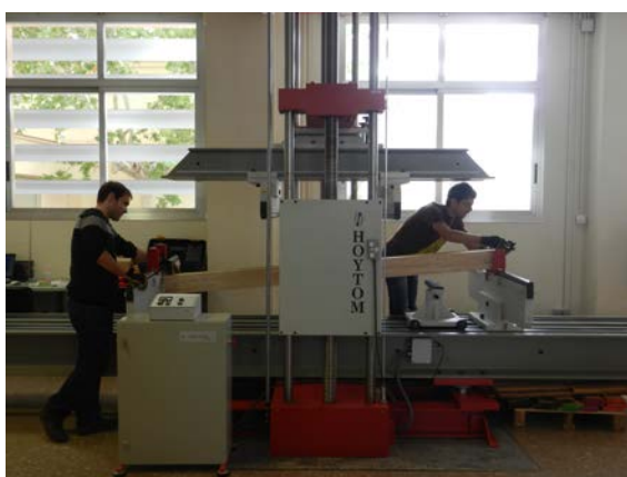
Figura 191. Col·locació d'una biga de fusta laminada encolada al pòrtic de flexió
