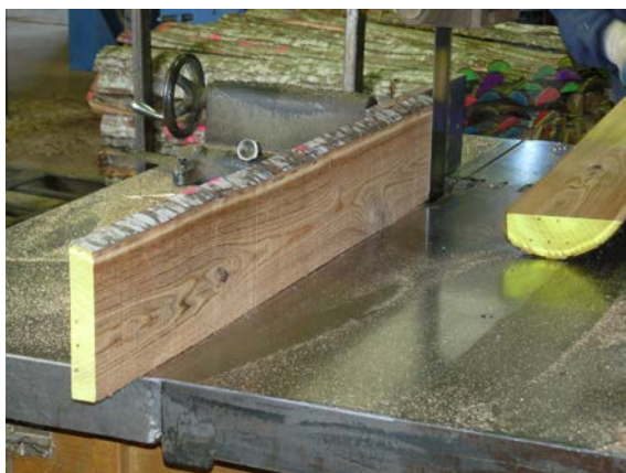
Figura 127. Desdoblament d'un tronc afectat per roig
