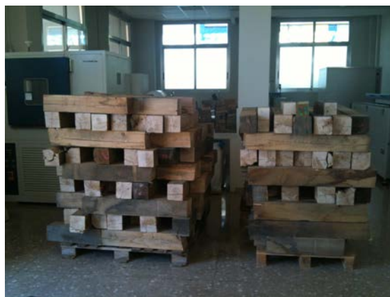
Figura 168. Restes de les bigues de castanyer després de l'assaig a flexió i extreure'n la llesca
