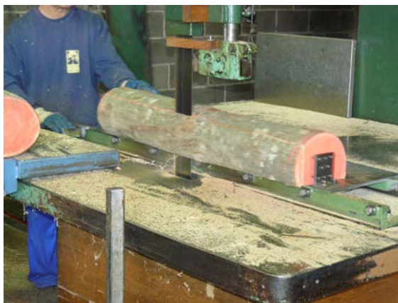
Figura 126. Desdoblament d'un tronc per obtenir els taulons
