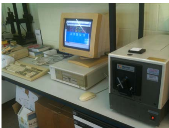
Figura 83. Espectrofotòmetre Macbeth Color-Eye 3000
