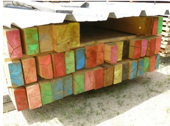
Figura 158. Bigues de castanyer identificades assecant-se al pati de la serradora
