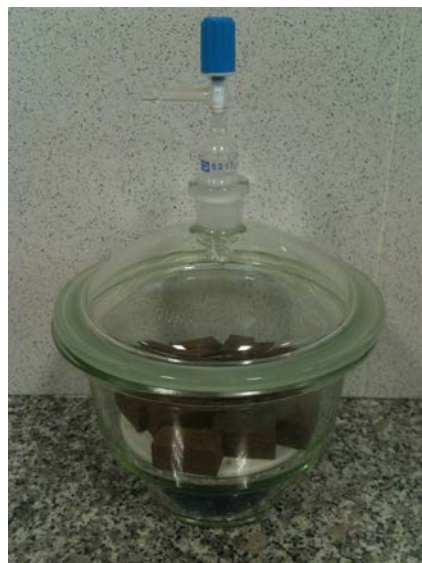
Figura 82. Provetes termotractades refredant-se en el dessecador
