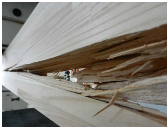
Figura 200. Assaig a flexió. Biga laminada de castanyer. Trencament per fusta
