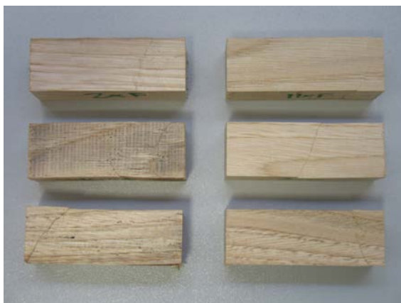
Figura 139. Detall de diferents trencaments a compressió axial
