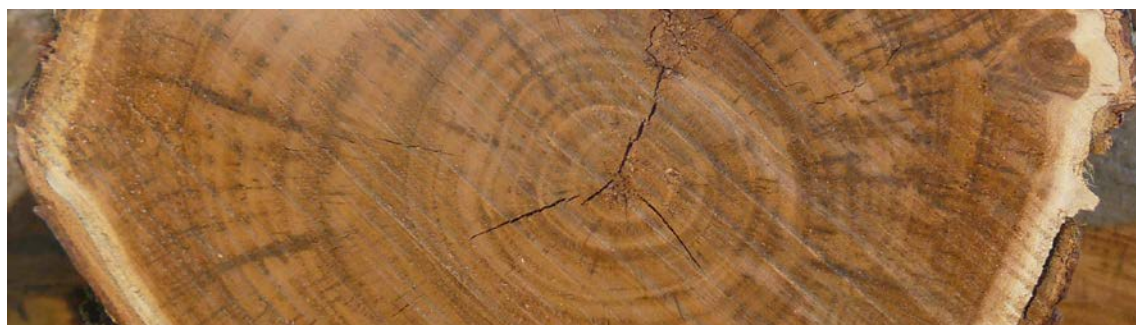
Figura 33. Roll de castanyer afectat per roig. Albeca sana, duramen clarament enrogit
