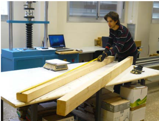
Figura 159. Classificació visual de fusta massissa estructural de secció rectangular
