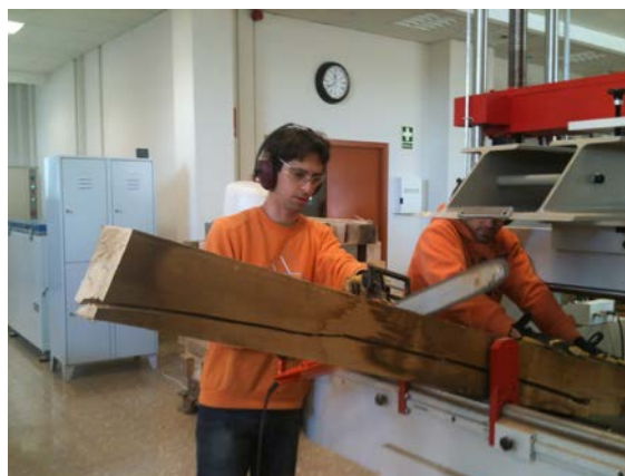
Figura 166. Especejament de la biga i obtenció de la llesca després de l'assaig a flexió
