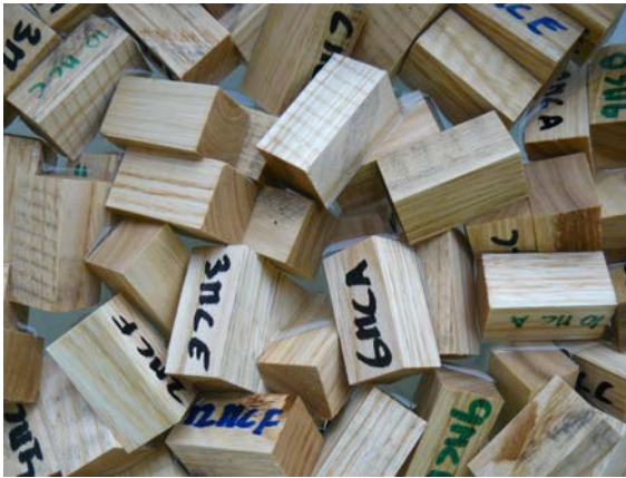
Figura 131. Provetes de castanyer en aigua. Assaig de contracció volumètrica
