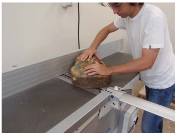
Figura 122. Raspallat de les rodanxes de castanyer
