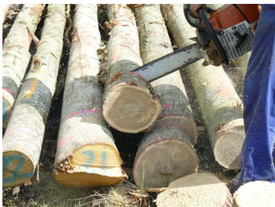
Figura 121. Extracció d'una rodanxa de la base del tronc per controlar l'edat i l'excentricitat
