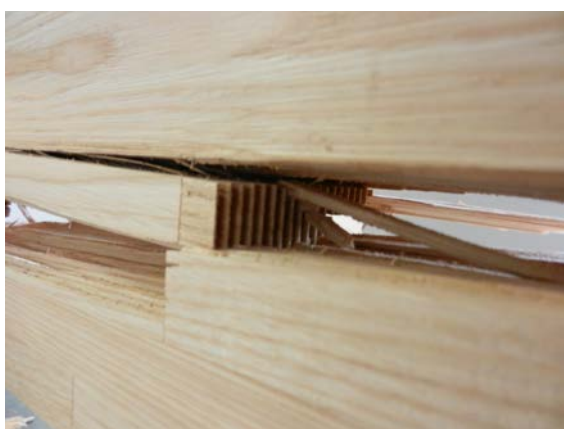
Figura 197. Trencament per línia de cola. Plans d'encolat trencats a cisalla
