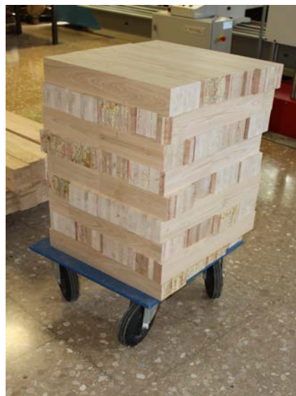
Figura 188. Testes extreïdes de les bigues per no sotmetre-les a esforços de cisalla durant la flexió
