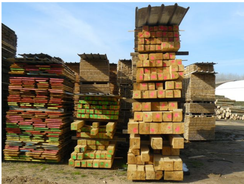
Figura 145. Elements estructurals assecant-se a l'aire lliure
