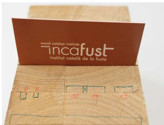
Figura 210. Provetna delaminada. Clivelles de delaminació indicades en verd
