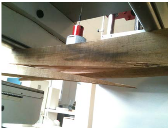
Figura 163. Biga trencada a flexió estàtica. Detall del flexòmetre per determinar la fletxa
