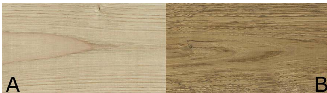
Figura 32. Fusta raspallada de duramen de castanyer: sana (A) i afectada per roig (B)
