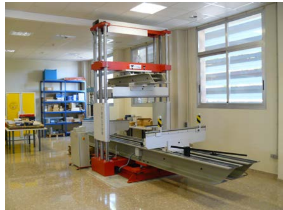
Figura 160. Pòrtic d'assaig a flexió
