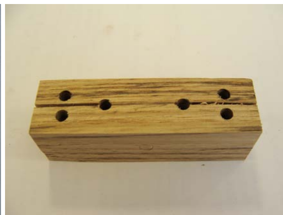
Figura 140. Proveta de resistència a tracció perpendicular
