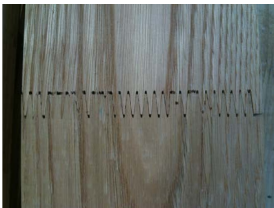
Figura 207. Unió dentada amb trencament mixt fusta/unió dentada
