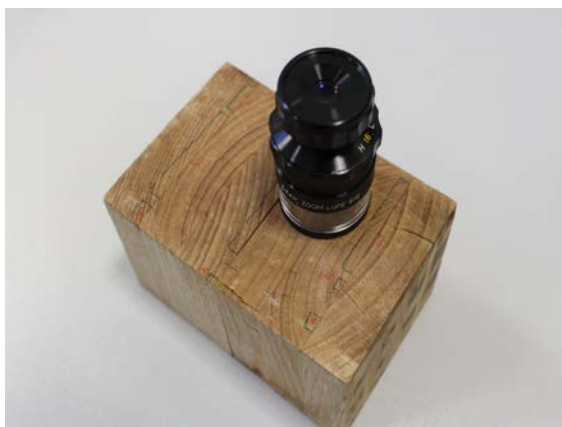
Figura 209. Provetna de delaminació. Lupa per observar les clivelles de delaminació
