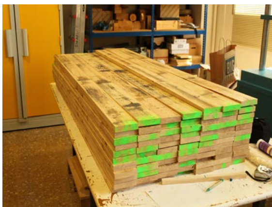
Figura 203. Làmines de castanyer empalmades per testa
