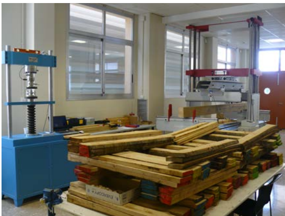
Figura 161. Pòrtic d'assaig, premsa multiassaig. Fusta de castanyer en primer terme
