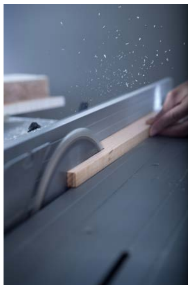
Figura 130. Serrat de les provetes lliures de defectes. Escairadora
