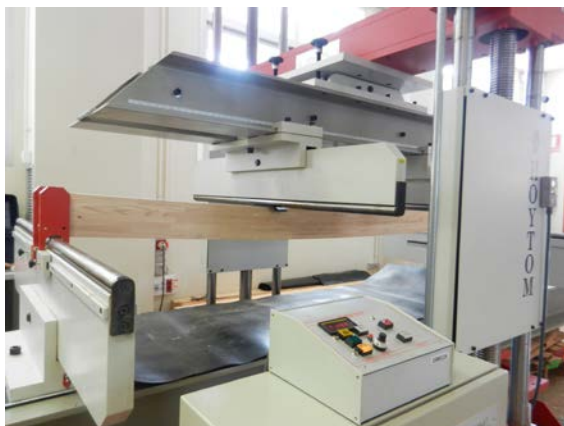
Figura 193. Biga de fusta laminada encolada sota càrrega durant l'assaig a flexió estàtica
