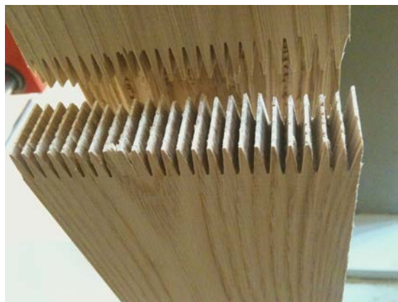
Figura 194. Unió dentada de la part inferior de la biga. Ruptura a tracció incorrecta
