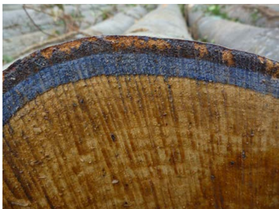
Figura 29. Roll marcat amb pintura biodegradable rentada després de dos anys a la intempèrie
