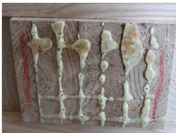
Figura 190. Detall de la cola de poliuretà dels plans d'encolat
