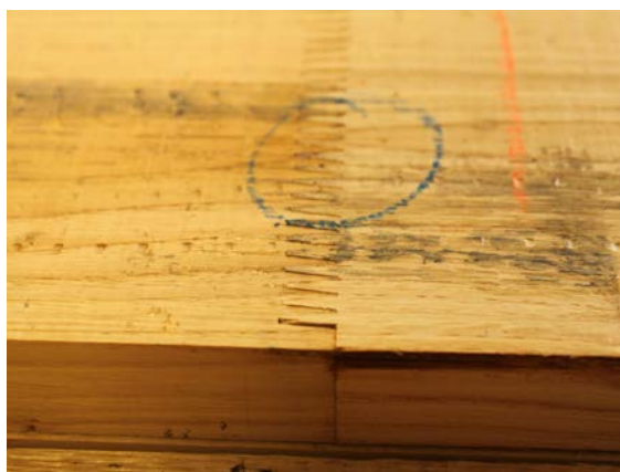
Figura 204. Detall de la unió dentada abans de l'assaig
