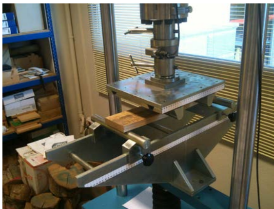
Figura 205. Assaig de flexió de les làmines encolades per testa amb unió dentada
