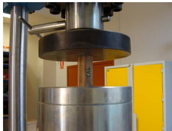
Figura 138. Assaig de resistència a compressió axial
