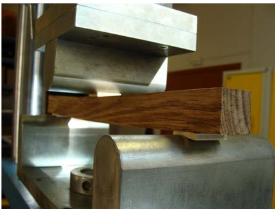
Figura 135. Detall del suport amb contraxapat per evitar la penetració del suport a la proveta
