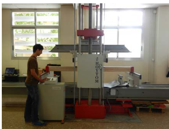
Figura 192. Ajust del pòrtic de flexió previ al inici de l'assaig a flexió estàtica
