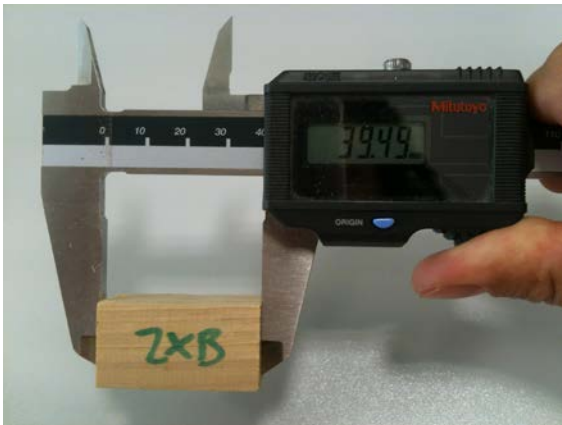
Figura 133. Mesura de les dimensions de les provetes. Assaig de densitat i contracció
