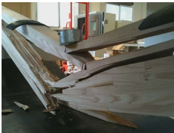
Figura 199. Assaig a flexió. Biga laminada de castanyer. Trencament per fusta
