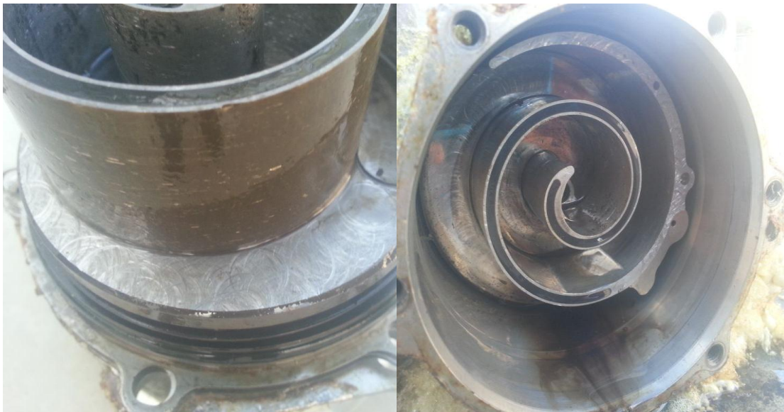
Figura D - 1. Estado de los materiales de fabricación del expansor posterior a su funcionamiento con amoníaco.
