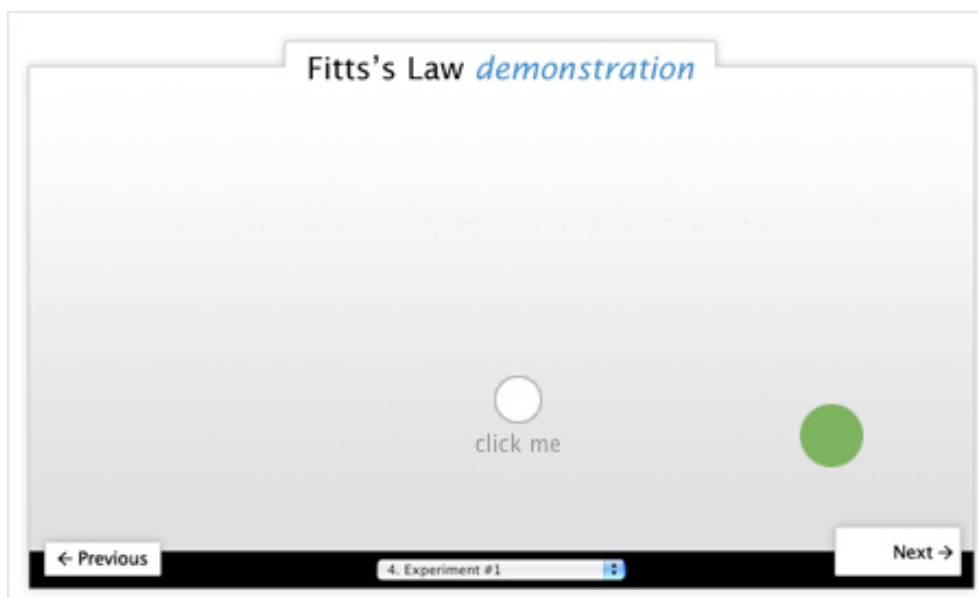
Fig. 4_156. En els experiments interactius de Wichary, l'usuari ha de seleccionar amb el ratolí cadascuna de les boles de colors que van apareixent en pantalla sempre després de fer clic sobre la bola blanca. Cada bola té una mida, un color i una distància diferents del punt de partida que sempre és la bola blanca.
