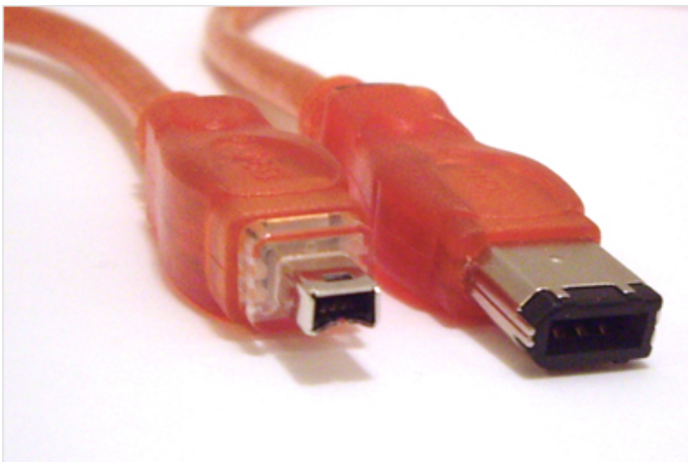
Fig. 4_152. Imatge dels cables firewire.
