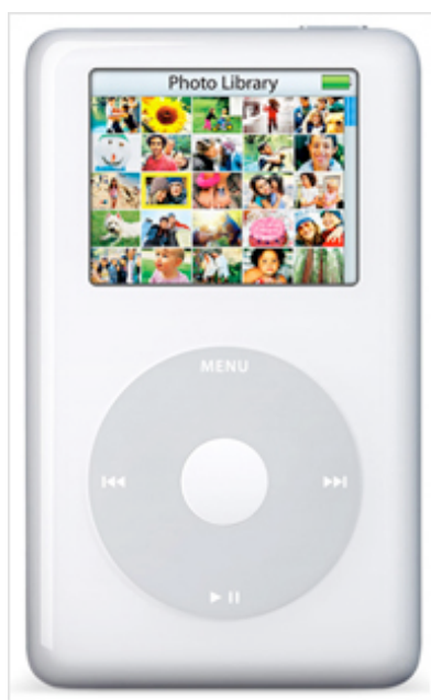
Fig. 4_177. L'iPod utilitza uns eixos amb el seu comandament circular que permet a l'usuari desplaçar-se ràpidament (trajecte) i sense esforç físic pels diferents apartats i seccions. La mateixa idea s'aplica, però, en les pantalles tàctils de la versió Touch.
