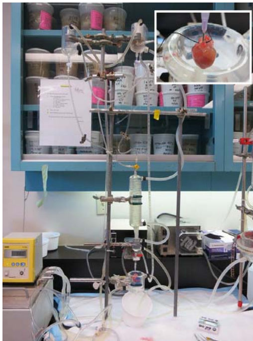
Figura 17: Aparell de Langendorff utilitzat per a l'aïllament enzimàtic de miòcits auriculars. En el detall del requadre superior-dreta s'observa una ampliació del cor i la perfusió retrògrada.
