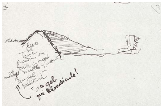
Carnet N 58 Dibujo # 391 Texto: levee de terre gradins sur dalles ciment mobiles décollés - ( attention au gel qui désarticule = au gel qui désarticule!
