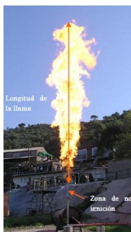
Figura 1.5 Incendio de chorro bifásico (propano).
