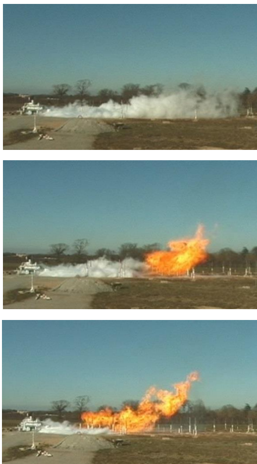
Fig. 3.21 Dispersión de la nube de GNL y desarrollo de la combustión durante una de las pruebas realizadas por Gaz de France (Daish et al., 2001).
