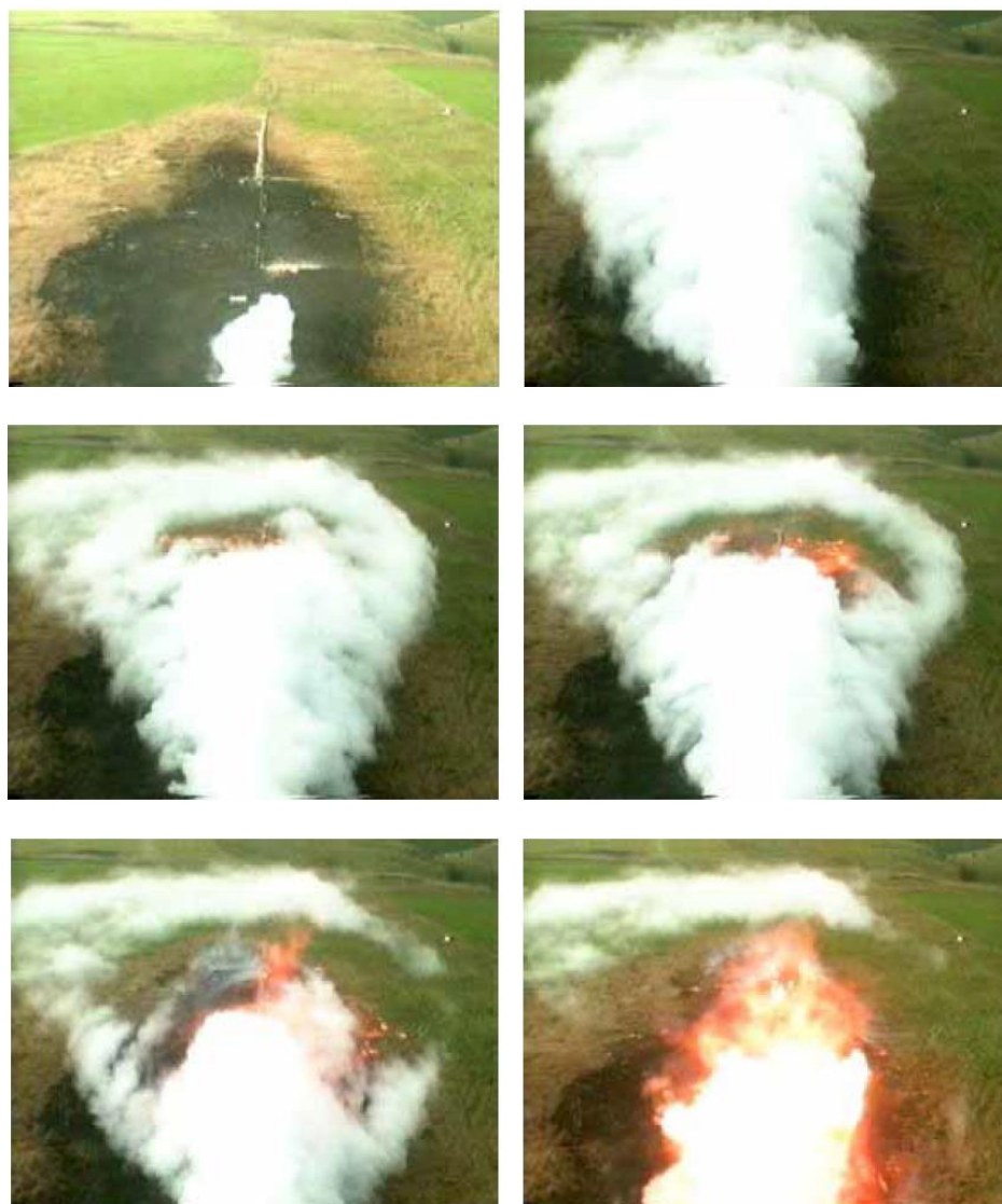
Fig. 3.22 Dispersión de la nube de GLP y desarrollo de la combustión durante la prueba 23 realizada por el HSL, desde los 2 s hasta los 43 s (Butler et al., 2001).
