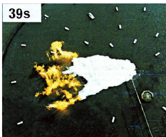
Fig. 1.3 Desarrollo del incendio de la nube de vapor de GNL durante la prueba 38 de la serie de Maplin Sands (Blackmore et al., 1982).
