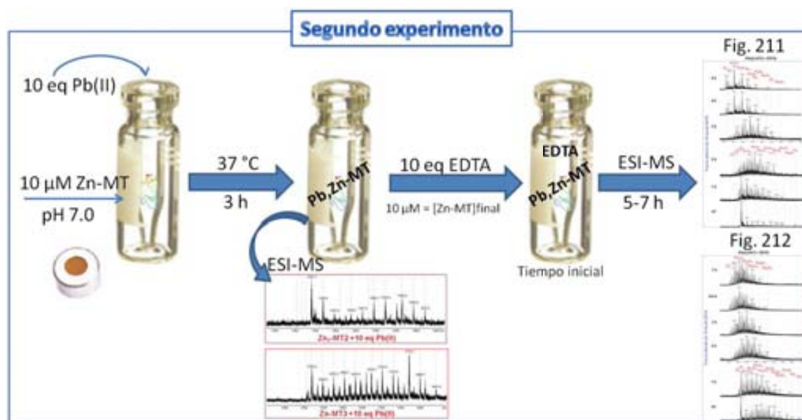
Figura 208. Esquema del segundo experimento del estudio de competición de las isoformas de MT de mamífero MT2 y MT3, frente a EDTA.
