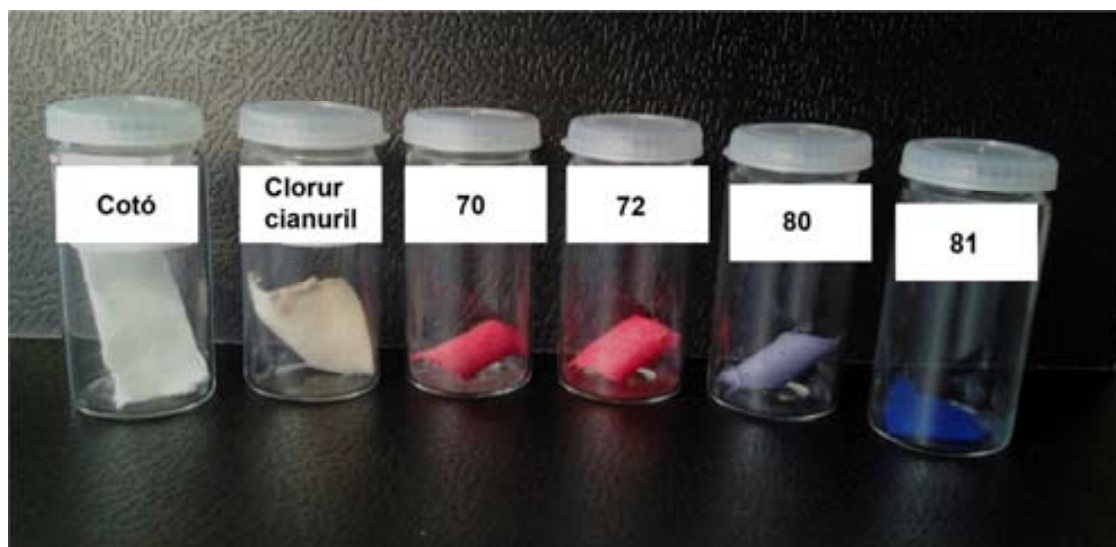
Figura 39 Teles tenyides amb els diferents colorants. Les dues de l'esquerra són els dos blancs, el primer és cotó rentat i el segon és una tela tenyida amb clorur de cianuril.
