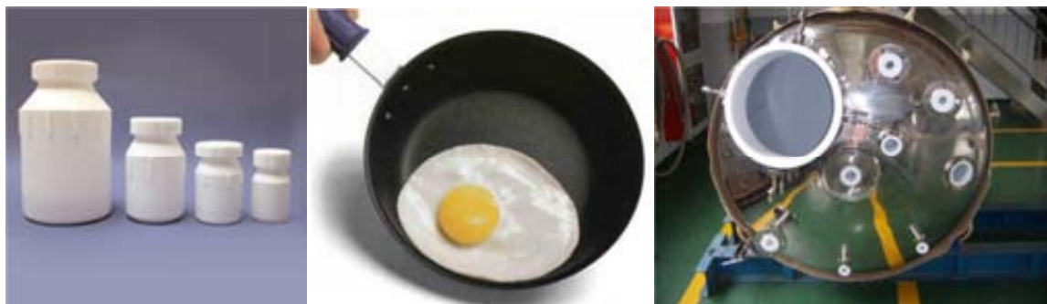
Figura 12 Diverses aplicacions del PTFE: envasos que no alteren el seu contingut, recobriments antiadherents i recobriments químicament inerts (d'esquerra a dreta).
