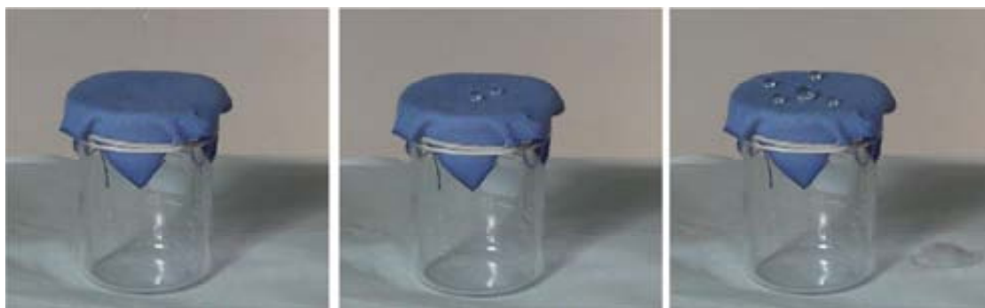
Figura 42 Selecció de fotogrames time-lapse del vídeo que demostra la impermeabilitat de la tela.
