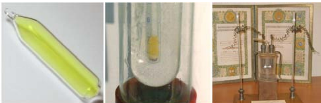
Figura 8 Fluor en estat gasós, en estat líquid (condicions criogèniques) i rèplica de la cel·la electrolítica usada per Moissan, amb el diploma Nobel de fons (d'esquerra a dreta).
