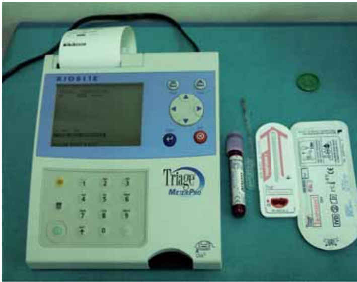
Figura 36 Alere Triage® MeterPro. El Alere Triage® MeterPro es una plataforma de pruebas diagnósticas rápidas que se realizan en el punto de atención al paciente. En nuestro experimento permitió realizar en el mismo quirófano determinaciones rápidas del nivel de Troponina I para confirmar enzimáticamente la presencia de lesión miocárdica. Se obtenía una muestra de sangre venosa. Con una pipeta del sistema se obtenía la alícuota exacta para la determinación, que se colocaba en una tarjeta de inmunoensayo. Tras 15 minutos de espera a temperatura ambiente, mientras se producía la reacción, dicha tarjeta era introducida en una ranura y en pocos minutos disponíamos del resultado. Inicialmente los tests se realizaron por duplicado para verificar la calidad de los mismos y su reproducibilidad en el modelo porcino.
