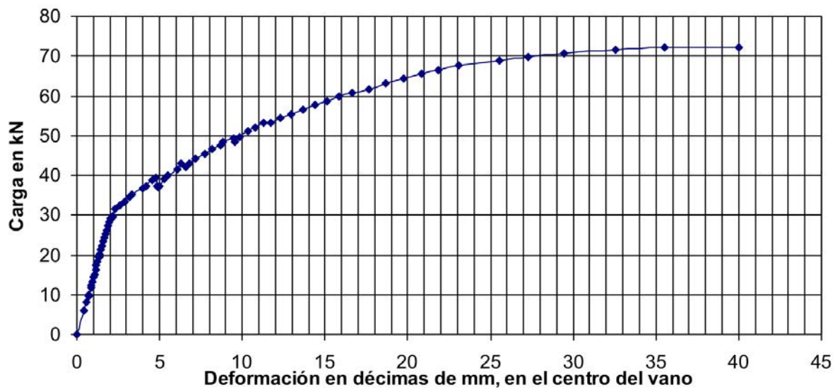
Figura A.16: Carga-deformación en el centro del vano, 20-T5-T12-CC8.
