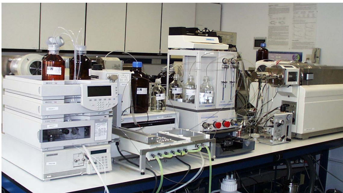
Figura 14. Sistema On-line SPE-HPLC-MS/MS utilizado para determinar los niveles de elomotecan y BN80960 en muestras plasmáticas de diferentes especies.
