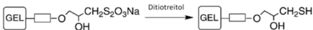
Figura 3.6. Esquema del resultado de la interacción de la sal de Bunte con el DTT para formar un gel con un grupo tiol.
