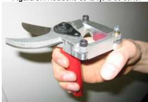
Figura 57. Rediseño de la tijera de corte.
