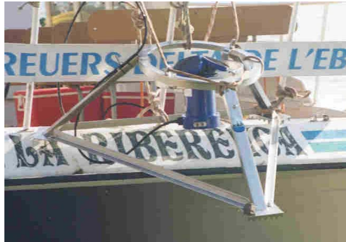
Figura. 3.26. Correntímetro Doppler Nortek (ADP), instalado en embarcación para tomar muestras en el estuario.
