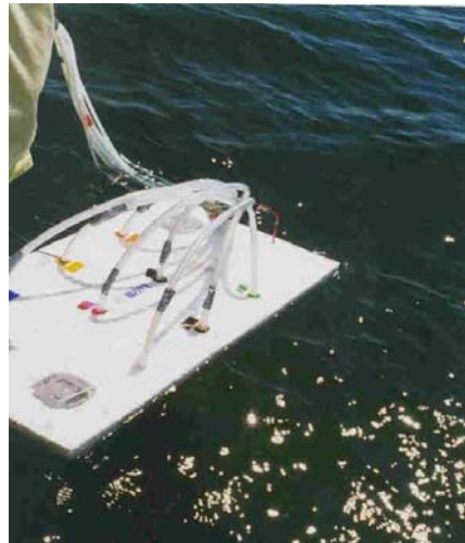
Figura 3.15. Sistema de muestreo de agua para la pluma del río, SWAS.
