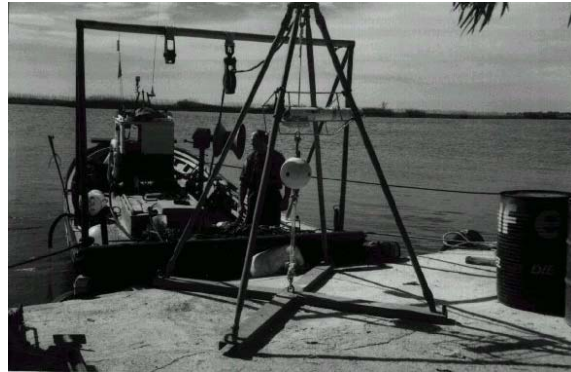
Figura 3.18.: Tetrápodo con el correntímetro S4DW.
