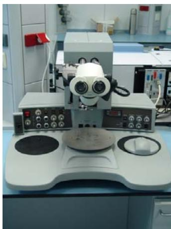
Figura A.12: Fotografía del microsoldador de punto que funciona con ultrasonido
