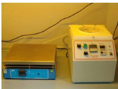
Figura A.9: Fotografía del spinner y la placa calefactora empleadas para el recubrimiento y cocido del PMMA y la fotoresina
