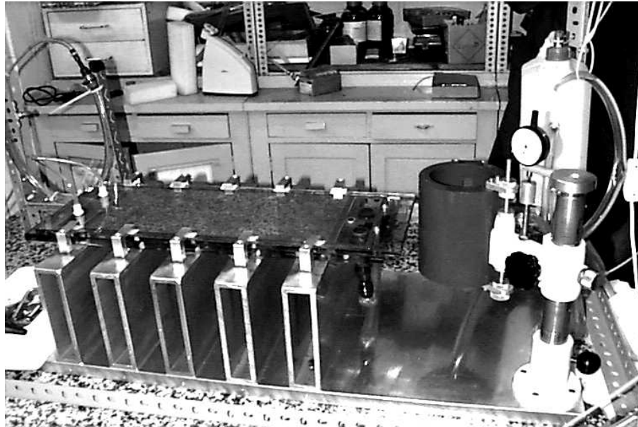
Figura 2.7: Fotografia de la cel·la de Hele-Shaw amb què s'han realitzat els experiments d'aquesta tesi. A la imatge es pot observar el dipòsit a l'entrada de la cel·la i el desordre entre les dues plaques. A la part dreta de la imatge es pot veure el sistema d'injecció que proporciona una pressió constant a l'entrada de la cel·la mitjançant una columna de fluid que manté l'alçada constant.
