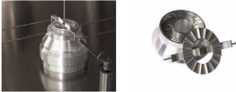
**Fig. 1.10.** Células de cizalla
