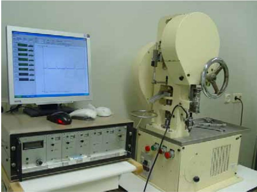
**Fig. 6.3.** Máquina de comprimir, amplificador y ordenador.
