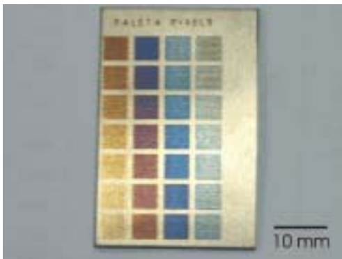
Fig. V.18. Paleta de píxeles realizada con la lente de 100 mm, 19 A de intensidad de la lámpara de excitación, 94 mm entre lente de focalización y substrato, 125 \mu\text{m} de distancia entre píxeles adyacentes y 50 ms de tiempo de espera. El tiempo de apertura aumenta de abajo arriba y de izquierda a derecha de 2 a 29 ms.
