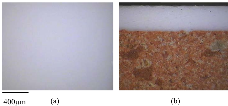
Fig. 2.10. Imagen de (a) la superficie esmaltada y (b) la sección transversal de un azulejo.
