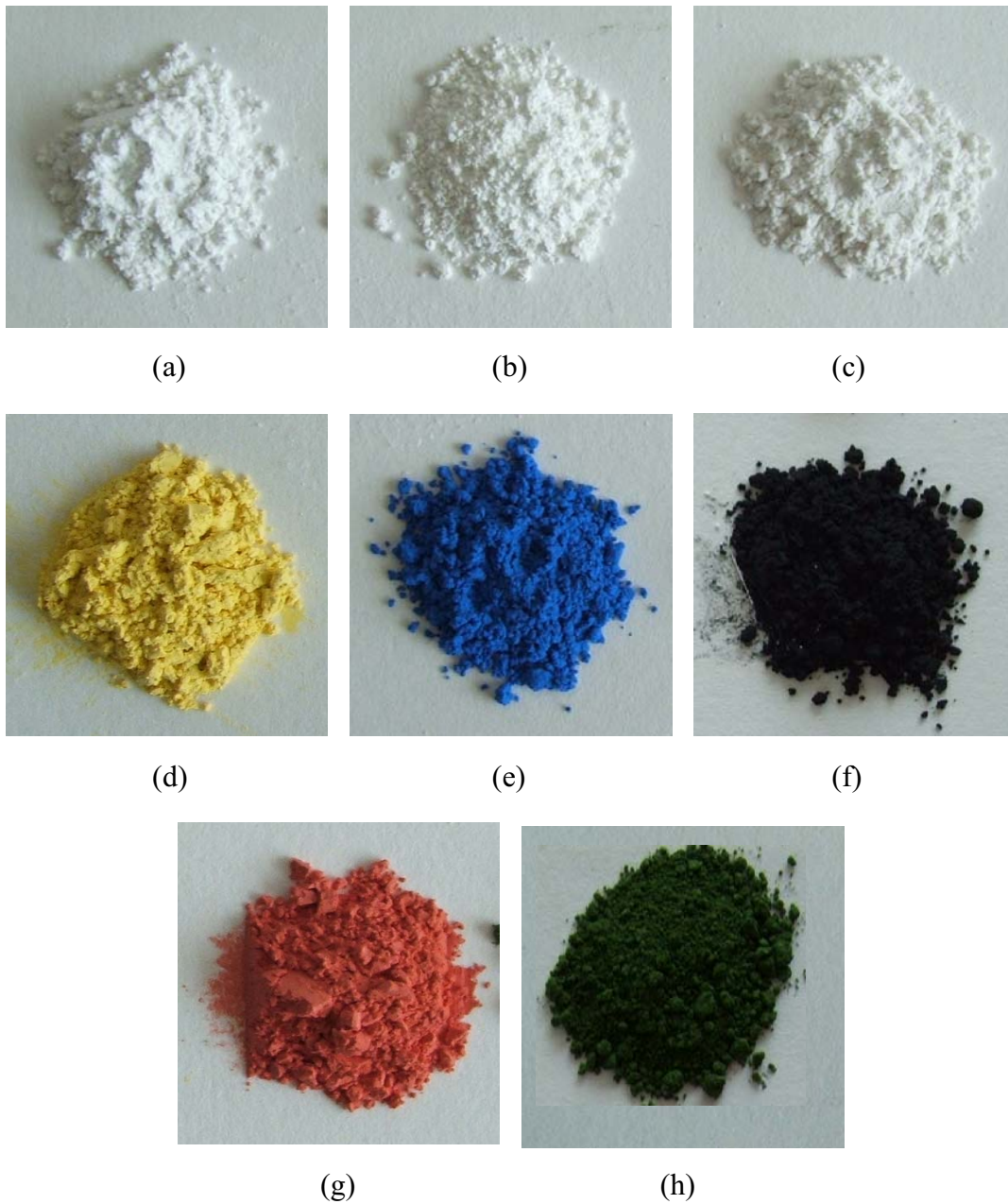
Fig. 2.12. Principales componentes de los barnices. Fritas (a) alcalina, (b) borácica y (c) plúmbica. Pigmentos (d) amarillo, (e) azul, (f) negro, (g) rojo y (h) verde.
