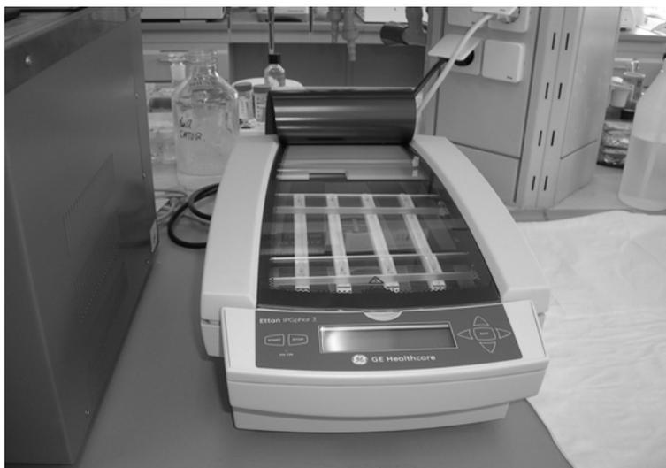
**Figura 3.7.** Equipo de IPGPhor utilizado para realizar la primera dimensión (IEF).
