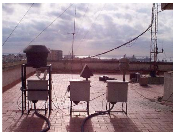
Figura 5.4.2. Equipos de muestreo de alto volumen de PST, PM10 y PM2.5 y monitor láser Grimm 1.107 en la terraza de la Delegació Territorial d'Agricultura, Ramaderia i Pesca (DARP) de la Generalitat en Tarragona.
