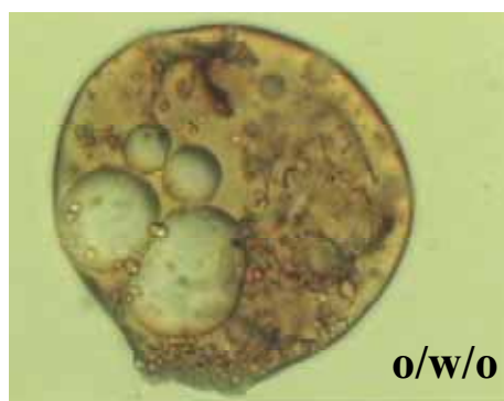
Fig. 1.10. Imagen de microscopía óptica de la emulsión múltiple crudo/agua/crudo observada en todas las proporciones testadas que provocaban emulsión: 20:60:20 (ramnolípido:crudo:agua); 20:20:60; 10:80:10; 10:70:20; 10:40:50; 5:15:80; 5:45:50. (Abalos et al. , 2001).
