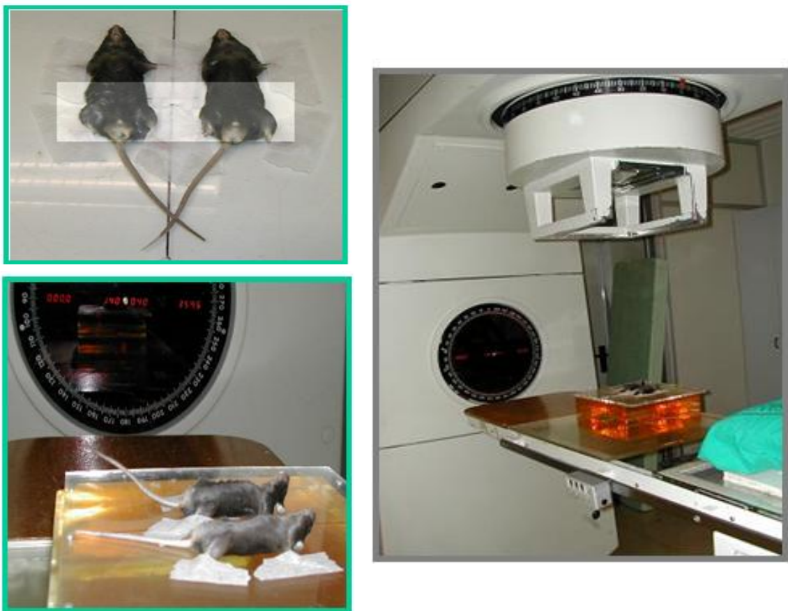
Figura 9. Model experimental: tècnica d' irradiació abdominal.
