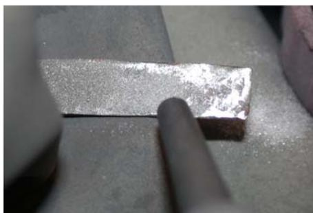
**Figura 67:** *Arenado de una muestra de Titanio grado 4.*
