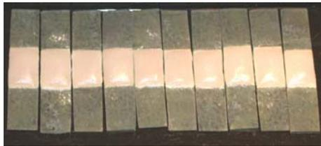
**Figura 71:** *Imagen de las 10 muestras de Cr-Ni usadas para el estudio.*
