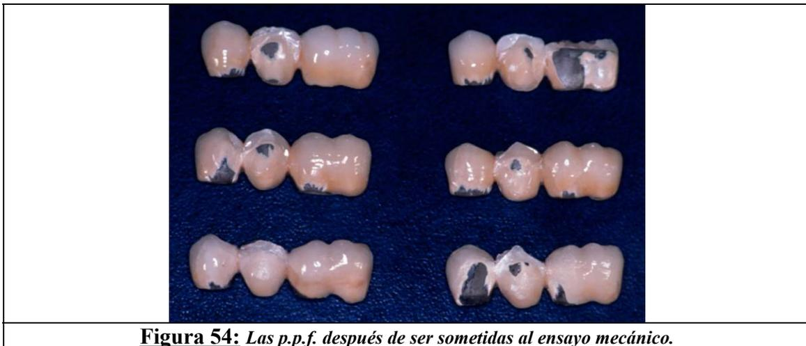
**Figura 54:** Las p.p.f. después de ser sometidas al ensayo mecánico.
