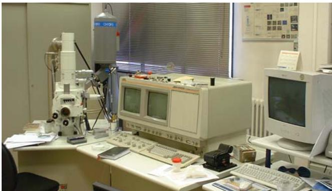
**Figura 65:** *Equipo de microscopía de barrido SEM JEOL ® JSM-6400 Scanning Microscopy.*
