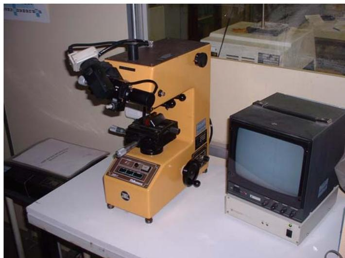
**Figura 63:** *Equipo de microdureza Vickers Matsuzawa ® DMH-1.*
