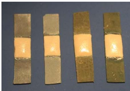
**Figura 69:** *Una muestra de cada una de las combinaciones. De izquierda a derecha: Titanio 4 colado-cerámica, Titanio 4 mecanizado cerámica, Cr-Ni-cerámica, Cr-Co-cerámica.*
