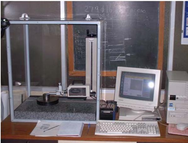
**Figura 64:** *Rugosímetro Mitutoyo ® modelo SV 502.*
