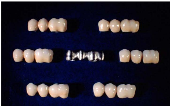
**Figura 52:** *Imagen de las prótesis parciales fijas elaboradas antes de los ensayos mecánicos. A la izquierda están las de titanio grado 3, a la derecha las de titanio grado 4. En el centro se observa el modelado de la estructura metálica.*
