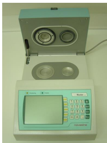
Figura 3.7. Equipo Novasina Lab MASTER-aw utilizado para la medida de la actividad de agua.
