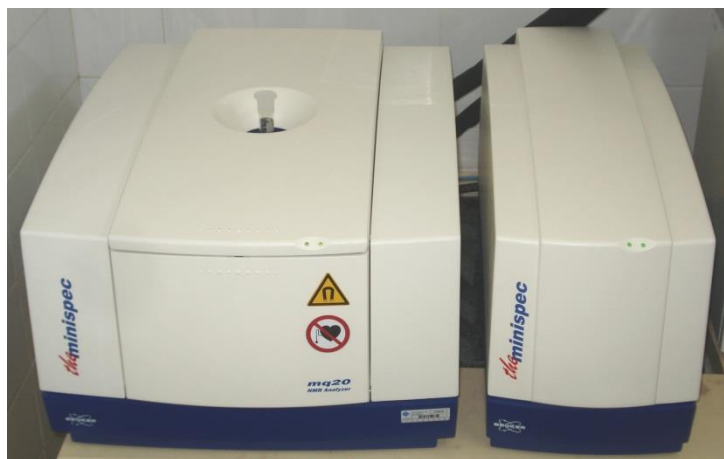
Figura 3.11. Espectrómetro de RMN de campo bajo minispec mq20. Unidad magnética (izquierda) y electrónica (derecha).
