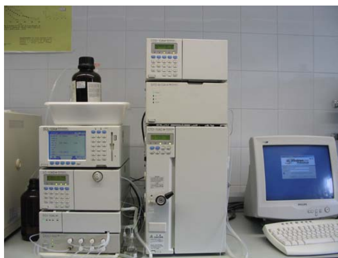
Figura 6.-19 Cromatògraf HPLC Shimadzu 10 Avp acoblat a un detector de conductivitat Shimadzu CDD 10 Avp per a la mesura d'ions \text{Cl}^- per cromatografia iònica.
