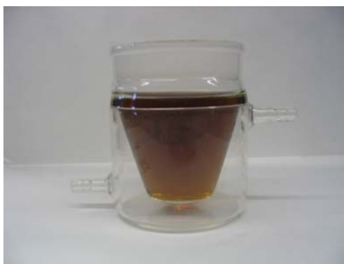
Figura 6.-1 Cel·la electrolítica cònica de 100 mL de capacitat amb camisa de termostatització.
