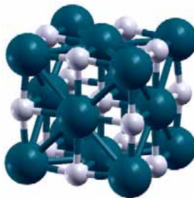
Figura III.14 — Estructura cúbica del Ti_{14}C_{13} .
