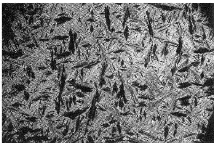
Figura 4.2.- Textura observada al microscopi d'un compost amb comportament de cristall líquid que presenta una mesofase SmA.
