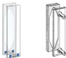
Fig. 4 Esquema de los dos modelos de cubetas utilizados de camino óptico l = 0,01 cm.
