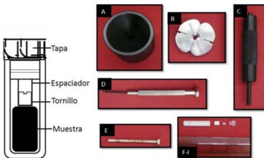
Figura 3.4 Esquema (izquierda) y fotos del rotor de HRMAS BL4 \text{ZrO}_2 y sus accesorios (derecha) para el análisis de muestras por espectroscopía de HRMAS. (A) embudo para cargar la muestra en el rotor ; (B) desenroscador de la tapa del rotor mostrado en F- I; (C) empaquetador de la muestra en el rotor; (D) destornillador para rotor MAS; (E) tornillo cilíndrico para el cabezal; (F-I) de izquierda a derecha: rotor BL4 \text{ZrO}_2 , espaciador, tornillo y tapa Kel-F(Kellogg and Fluoropolymer).
