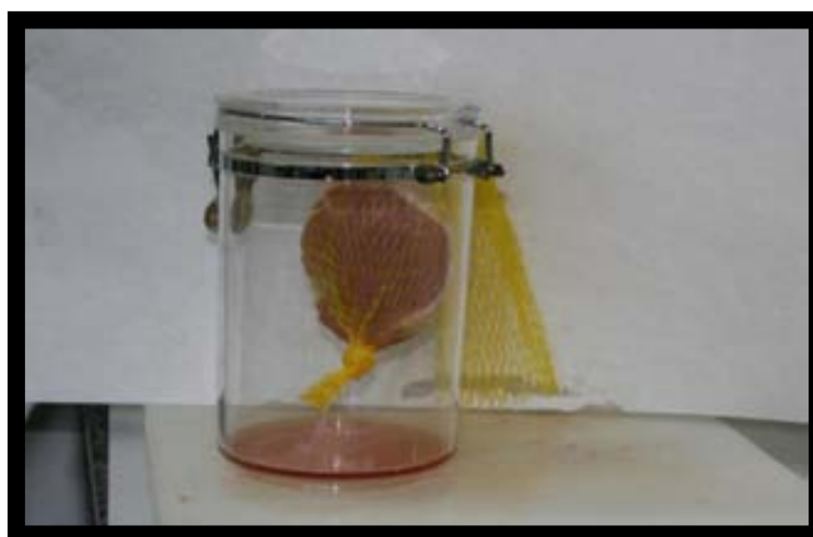
Figura 6. Método de la pérdida por goteo más utilizado actualmente: The bag Method (Fuente: Honikel, 1997).
