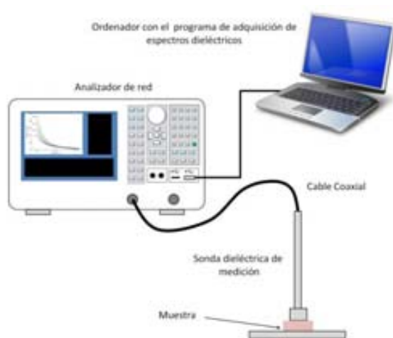
Figura 17. Esquema de un equipo para medir la intensidad de las constantes dieléctricas con la frecuencia.
