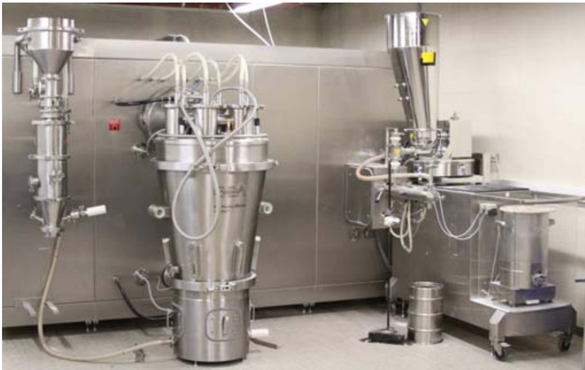
Figura 2 - 4: ConsiGma-25, el granulador- secador en lecho fluido utilizado en este estudio.
