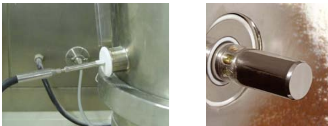
Figura 3 - 30: sondas implementadas; Nicolet Antaris II (izquierda) y LightHouse (derecha)
