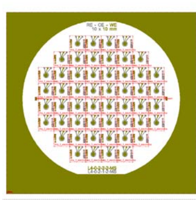
Figura A.2.: Diseño de la máscara de acetato de los chips con WE de Au y RE y CE de Pt.
