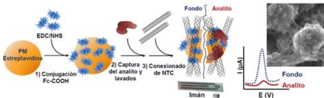
Figura 7.17.: Esquema en la que se representa (1) la modificación de las PM-Fc; (2) la captura del analito y los lavados; (3) el conexionado con NTC y la respuesta, en la que se ve como el analito sombrea los Fc generando una disminución de la señal electroquímica [241].
