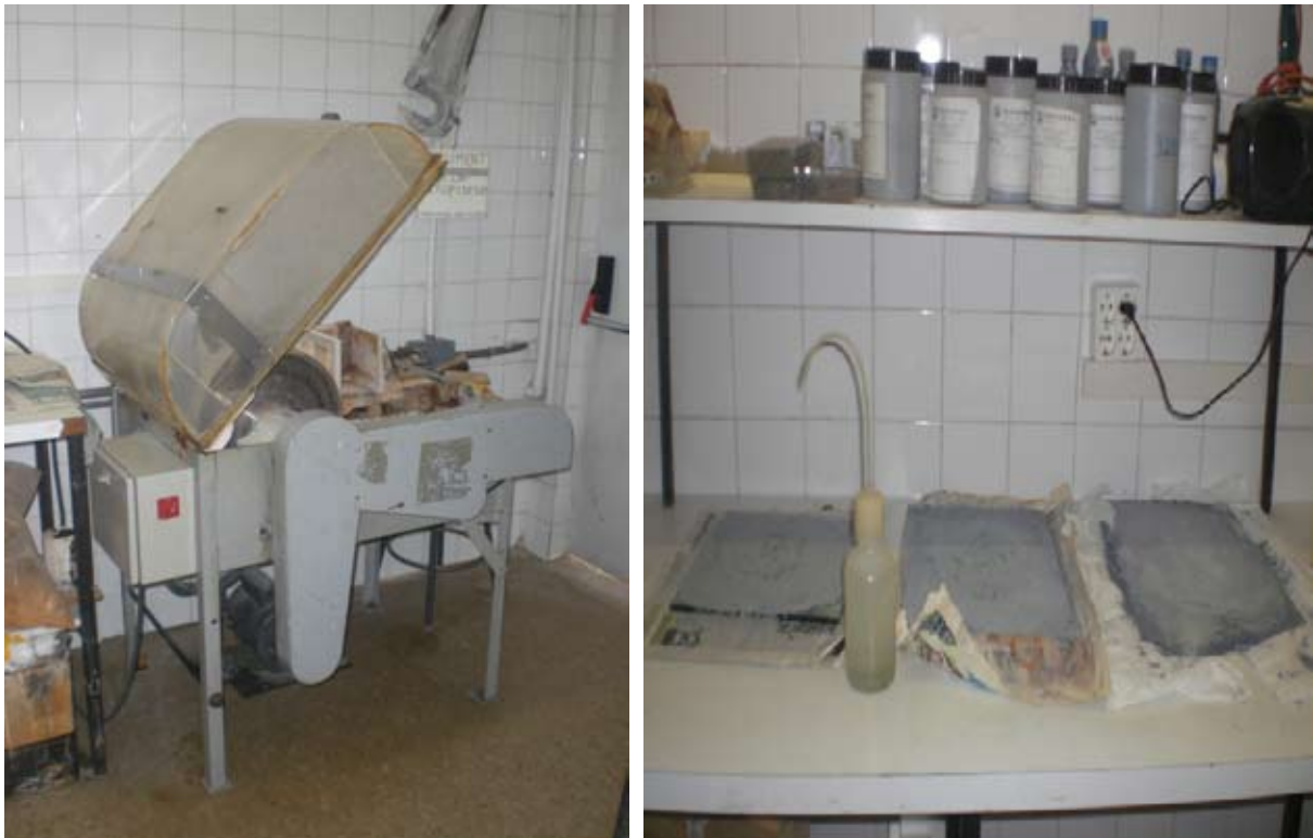
Fig. 6- Vista general de la máquina utilizada para el corte del material y la repisa donde se pulen los ejemplares cortados a través del carborundum.
