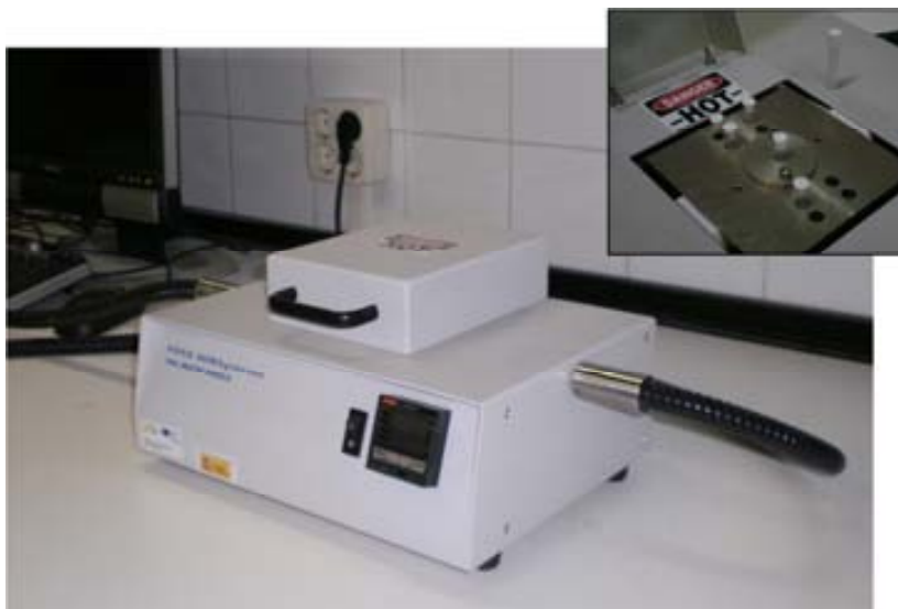
Figura 5.1. Detalle del módulo VHM, acoplado al espectrofotómetro NIR.
